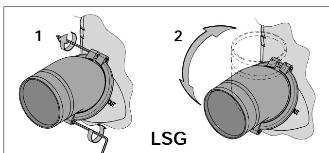
Para facilitar el montaje de la manguera en las conexiones de manguera, utilizar exclusivamente agua y/o jabón, y no productos que contienen grasa o aceite.
