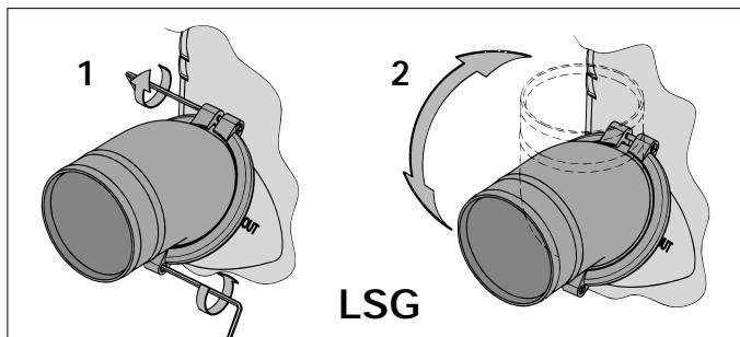
Utiliser uniquement de l'eau et/ou du savon, et non pas des produits gras ou huileux, pour faciliter le montage du tuyau sur les raccordements.
