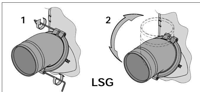
Verwenden Sie bitte für die Vereinfachung der Montage des Schlauchs an die Schlauchverbindungen ausschließlich Wasser und/oder Seife und keine fett- oder ölhaltigen Produkte.
