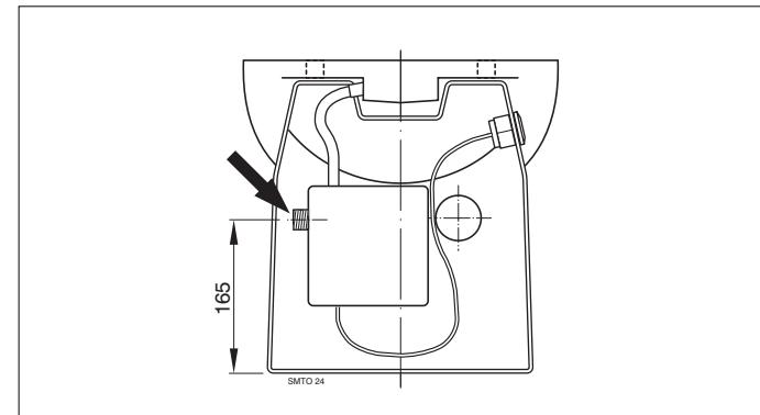
Équiper l'arrivée d'eau d'un robinet à boule avec un raccordement 3/4" extérieur.
