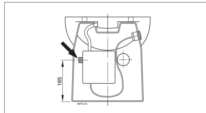
Wasserversorgung mit einem Kugelhahn mit einem 3/4"-Anschluss auswendig versehen.
