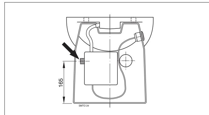
Asegure que la tubería de agua tenga un tapón esférico con una conexión de 3/4" de pulgada para uso externo.
