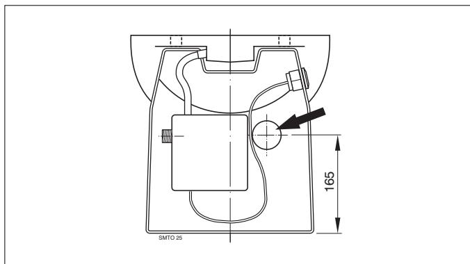
Monte la válvula de retorno (F) usando la abrazadera de manguera (G).
