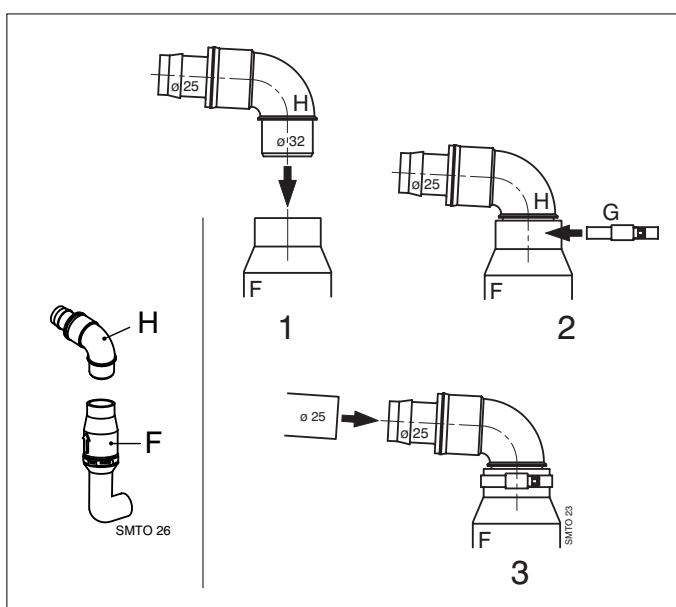
Comme conduite d'évacuation prendre un tuyau de  $\varnothing$  25 mm (par exemple le 'tuyau anti-odeurs pour eaux usées de Vetus'  $\varnothing$  25 mm).
