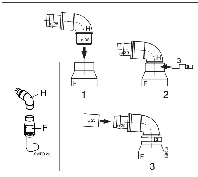
Use como tubería de desagüe una manguera con Ø de 25 mm (por ejemplo, una 'manguera de desagüe antiolores de Vetus con Ø de 25 mm').
