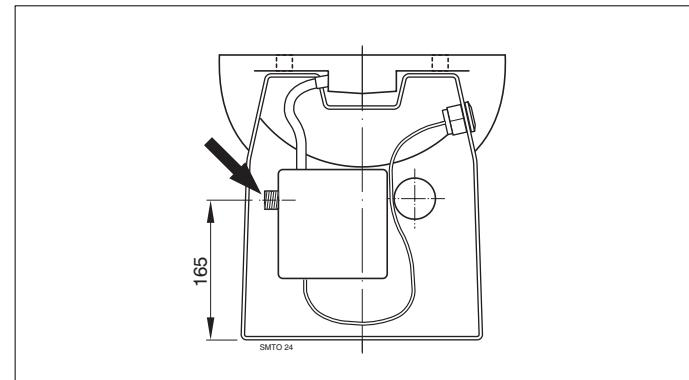
Voorzie de watertoevoer van een kogelkraan (hoekstopkraan) met een aansluiting van 3/4" uitwendig.
