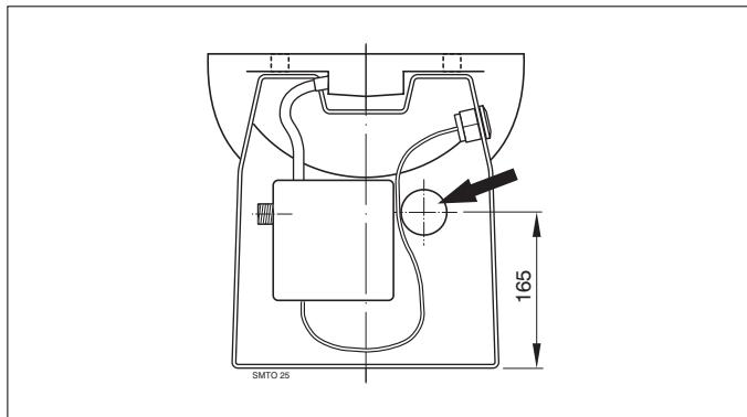
Monter le clapet antiretour (F) avec la bride de tuyau (G).
