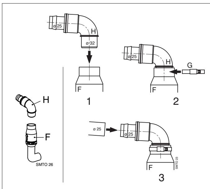
Utilizzate un tubo di  $\varnothing$  25 mm come tubo di scarico (ad esempio un 'tubo salvaodore Vetus per acque nere'  $\varnothing$  25 mm). Fissate il tubo di scarico con le fascette in dotazione.
