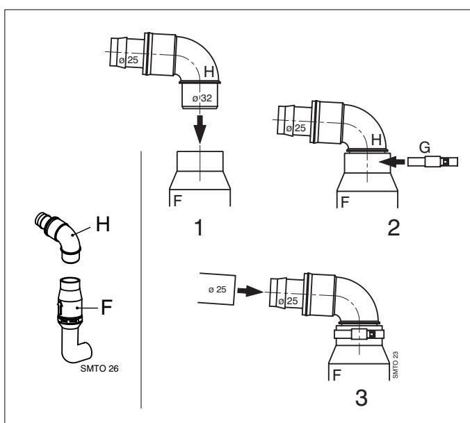
Als Abflussleitung einen  $\varnothing$  25 mm-Schlauch benutzen (zum Beispiel den geruchsfreien Vetus-Abwasserschlauch  $\varnothing$  25 mm). Den Abfluss mit den Klemmen befestigen.
