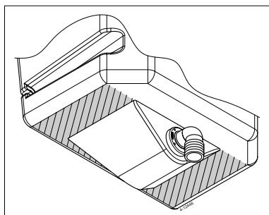
Potete utilizzare un profilo angolare per sostenere il serbatoio.
