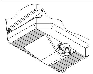
Le réservoir peut par exemple être soutenu à l'aide d'un profilé d'angle.
