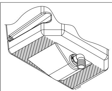
Der Tank kann beispielsweise mit einem Eckprofil gestützt werden.
