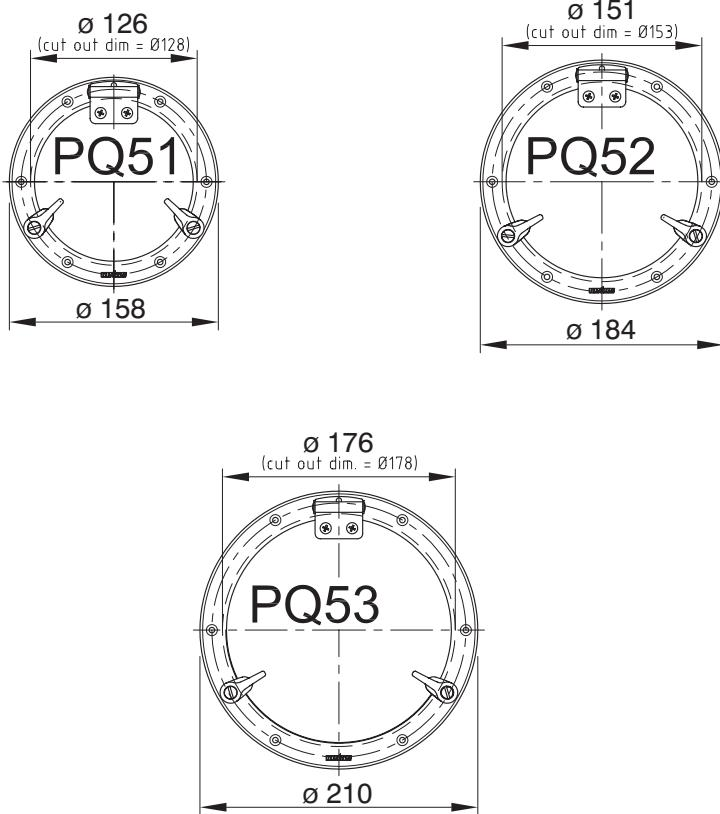
De bij de streeplijnen aangegeven afmetingen zijn de inbouwmaten.
