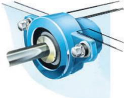
Hydradrive wird nicht mit irgendeiner Form von Schott geliefert. Alle Boote verlangen alle ihr individuelles Schott. Das Schott kann aus verschiedenen Materialien bestehen, z.B: Stahl, Aluminium oder glasfiberverstärktes Polyester mit mind. 5 – 6 Schichten glasfiber am Furnier. Unter voller Belastung darf das Drucklagerschott sich nicht bewegen. Es muss stark genug sein um den vollen Propellerdruck absorbieren zu können.
